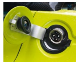
La presa per la ricarica: per fare il «pieno» ci vogliono sette-otto ore. A sinistra, la Tesla Roadster nel traffico del Lungotevere. In alto, una silenziosa sortita in piazza del Popolo
